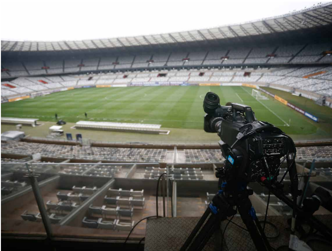
16m/ Off Side (5 y 6): Dos cámaras instaladas exactamente en las líneas 16.5m, líneas de off side, al mismo nivel o más alto que la plataforma de la cámara principal.
