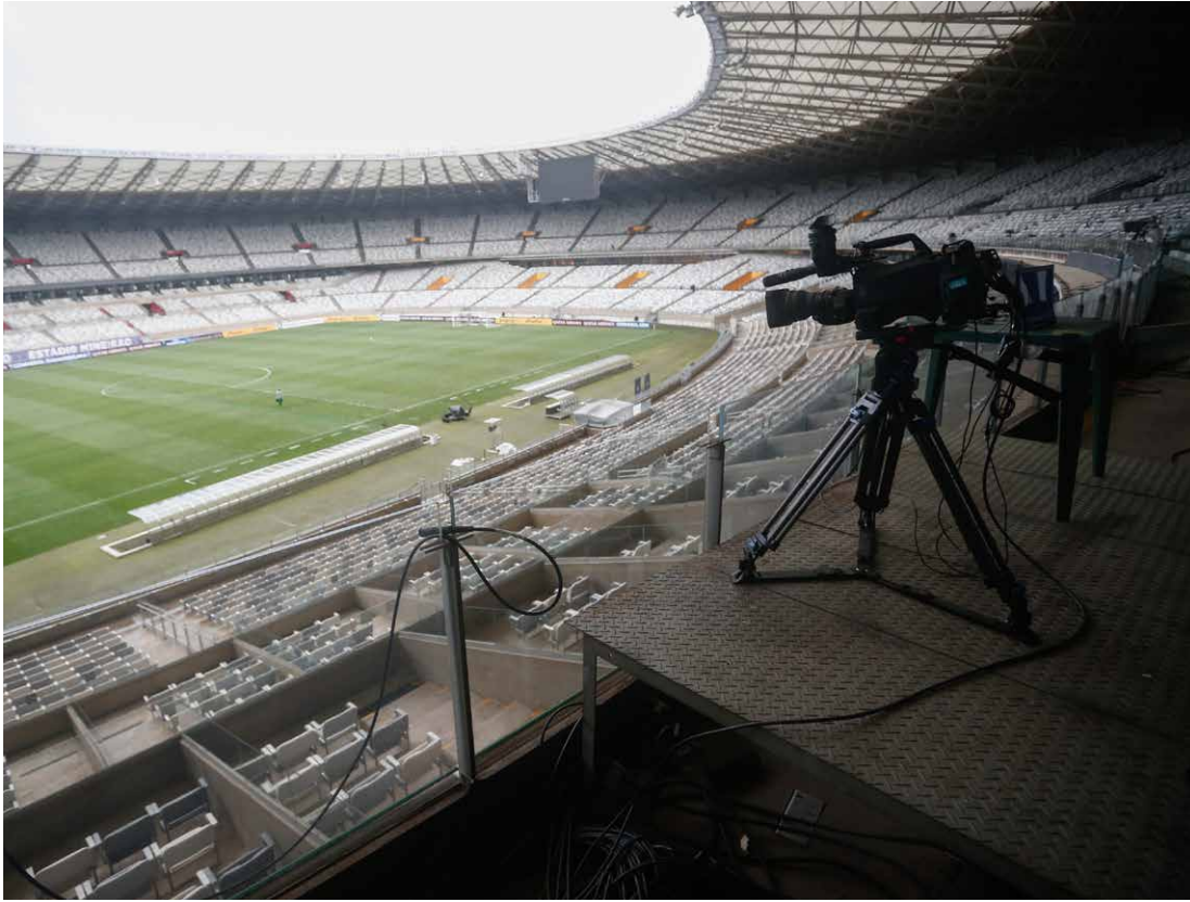
16m/ Off Side (5 y 6): Dos cámaras instaladas exactamente en las líneas 16.5m, líneas de off side, al mismo nivel o más alto que la plataforma de la cámara principal.
